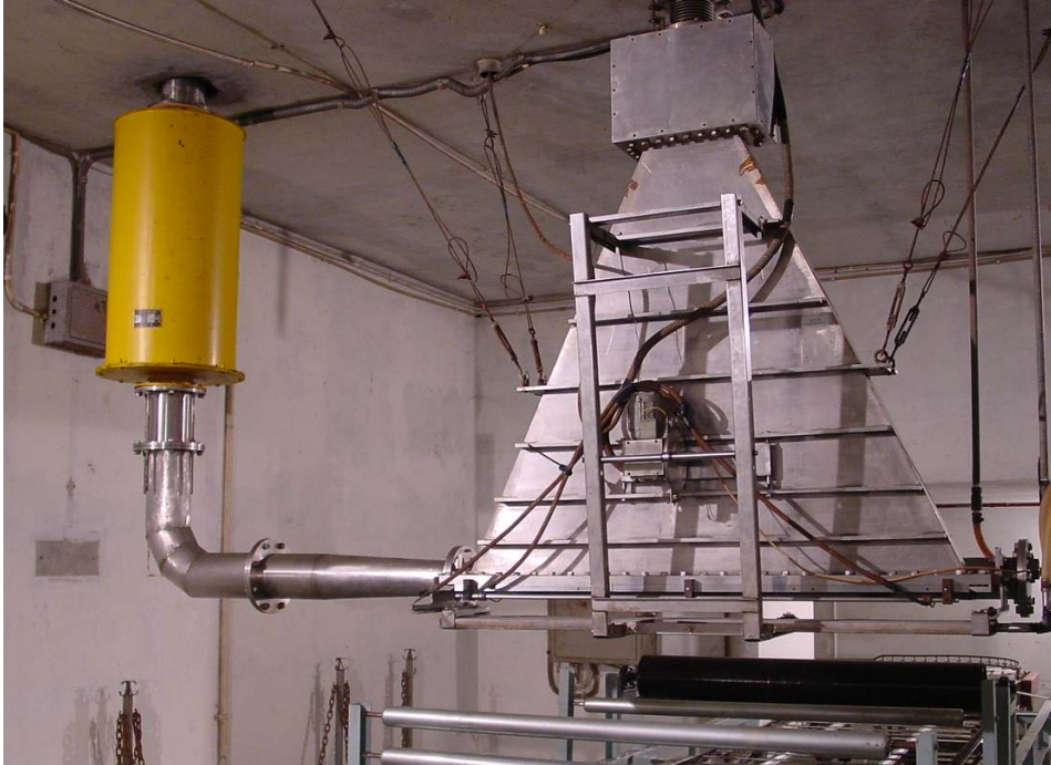
Gb. 3 Salah satu mesin berkas elektron konvensional (tipe filamen panas) yang ada di BATAN
